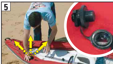
5 Unscrew both cap and base. Deflate. Dévisser l'ensemble bouchon + support de bouchon. Dégonfler.
