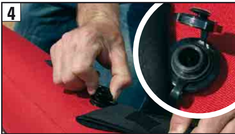
4 Open the main cap. Ouvrir le bouchon.
