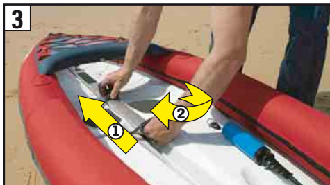
3 Slide back the aluminium beam. Glisser la poutre en alu vers l'arrière.
