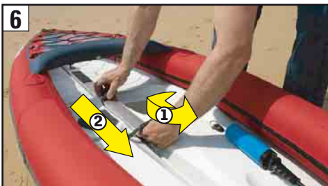
6 Slide the beam towards the front. Glisser la poutre à fond vers l'avant.
